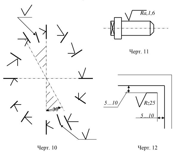
Примечание – При расположении поверхности в заштрихованной зоне обозначение наносят только на полке линии-выноске.
