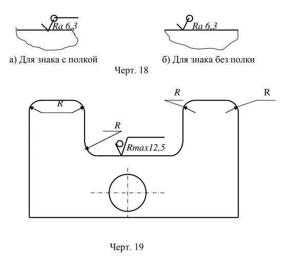
4.13 Обозначение одинаковой шероховатости поверхности сложной конфигурации допускается приводить в технических требованиях чертежа со ссылкой на буквенное обозначение поверхности, например: «шероховатость  $A - \sqrt{Ra\ 1,6}$ ». При этом буквенное обозначение поверхности наносят на полке линиивыноски, проведенной от утолщенной штрихпунктирной линии, которой обводят поверхность на расстоянии 0,8...1 мм от линии контура (черт.20).
