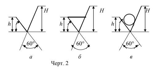
Высота h должна быть приблизительно равна применяемой на чертеже высоте цифр размерных чисел. Высота H равна 1,5 h. Толщина линий знаков должна быть приблизительно равна половине толщины сплошной основной
