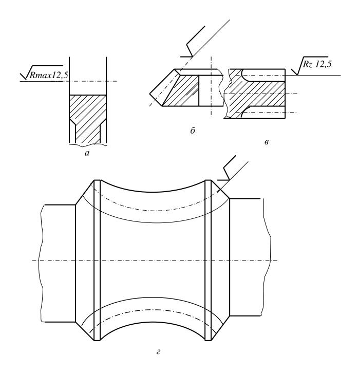
4.11 Обозначение шероховатости поверхности профиля резьбы наносят по общим правилам при изображения профиля (черт. 17a) или условно на выносной линии для указания размера резьбы (черт. 17 $\delta$  , $\epsilon$  , $\epsilon$ ,  $\delta$ ), на размерной линии или на
